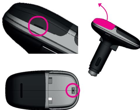
Mittig in der gekennzeichneten Öffnung befindet sich ein kleiner Schalter, mit dem das Gerät manuell auf die Werkseinstellungen zurückgesetzt werden kann. Drücken Sie diesen mithilfe eines kleinen dünnen Gegenstands (z.B. eine Stecknadel) und halten ihn für 6 Sekunden gedrückt damit das Gerät zurückgesetzt wird. Beachten Sie, dass das Gerät dafür in Betrieb sein muss.
